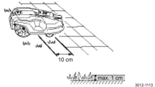
Wenn der Arbeitsbereich durch einen Weg mit Steinpflaster auf gleicher Ebene wie der Rasen getrennt wird, ist der Mähroboter in der Lage, auch über den Weg zu fahren. Es kann sogar von Vorteil sein, das Begrenzungskabel unter dem Steinpflaster zu verlegen. Das Begrenzungskabel kann auch zwischen den einzelnen Steinen des Pflasters verlegt werden. Stellen Sie sich, dass die Fliesen auf der gleichen Höhe mit dem Rasen sind, um übermäßigen Verschleiß des Mähroboters zu verhindern.
