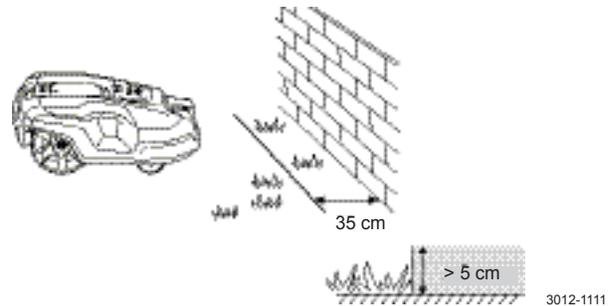
Wenn der Arbeitsbereich an einen kleinen Graben, wie zum Beispiel ein Blumenbeet, oder eine kleine Anhöhe oder eine niedrige Steinkante (1-5 cm) grenzt, sollte das Begrenzungskabel in einem Abstand von 30 cm in den Arbeitsbereich hinein verlegt werden. Dadurch wird verhindert, dass die Räder in den Graben oder auf die Steinkante fahren, was zu übermäßigem Verschleiß am Mähroboter, insbesondere an den Vorderrädern führen kann.
