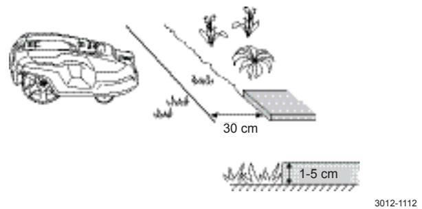
Wenn der Arbeitsbereich an einen Weg mit Steinpflaster oder Ähnlichem grenzt (+/- 1 cm), der sich auf gleicher Ebene wie der Rasen befindet, ist der Mähroboter in der Lage, auch ein wenig über den Weg zu fahren. Das Begrenzungskabel sollte dann 10 cm von der Wegkante entfernt verlegt werden.
