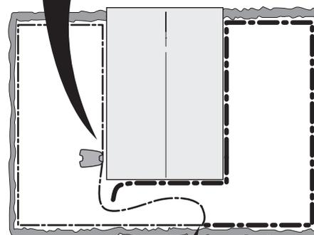
Leuchtet die Anzeigelampe grün, befindet sich der Bruch an einer Stelle zwischen dem ausgesteckten Ende und der Stelle, an der das neue Kabel angeschlossen wurde (dicke schwarze Linie in der Zeichnung).
