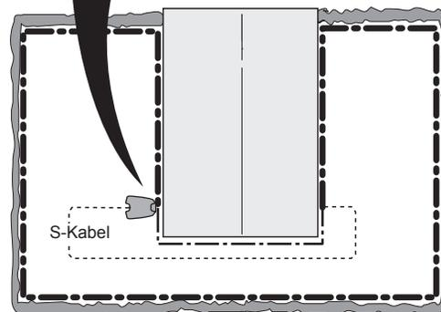
4. a) Folgendes gilt für den Fall, dass die Anzeigelampe bei Test 3a) dauerhaft grün geleuchtet hat. Alle Anschlüsse in den ursprünglichen Zustand zurückversetzen. Dann Begrenzungskabel AR trennen. Ein neues Schleifenkabel an AR anschließen. Das andere Ende des Schleifenkabels irgendwo in der Mitte der Installation anschließen.
